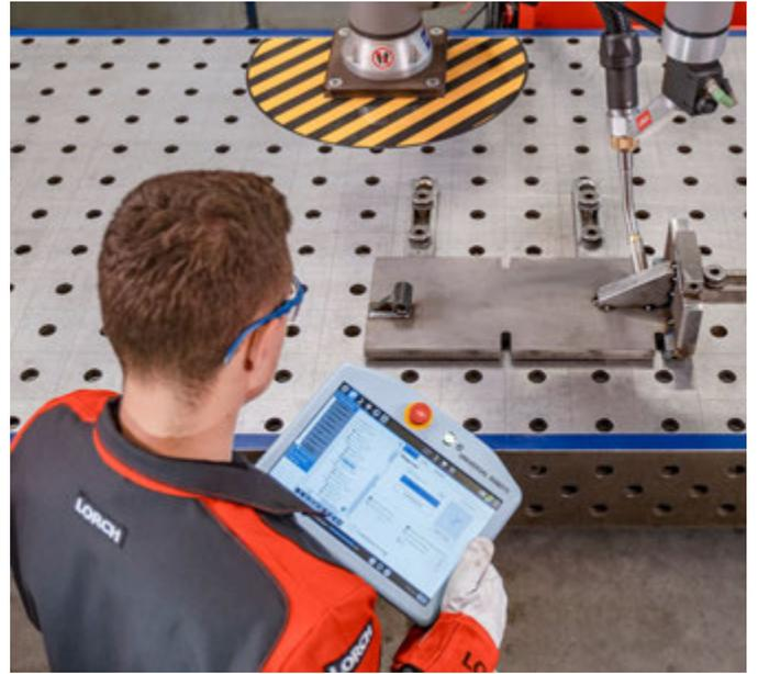
Einfache Handhabung: Der Cobot wird vom Anwender per Hand dorthin gezogen, wo geschweißt werden soll. Für die Einstellung des Roboters benötigt man keine Vorkenntnisse im Programmieren.
