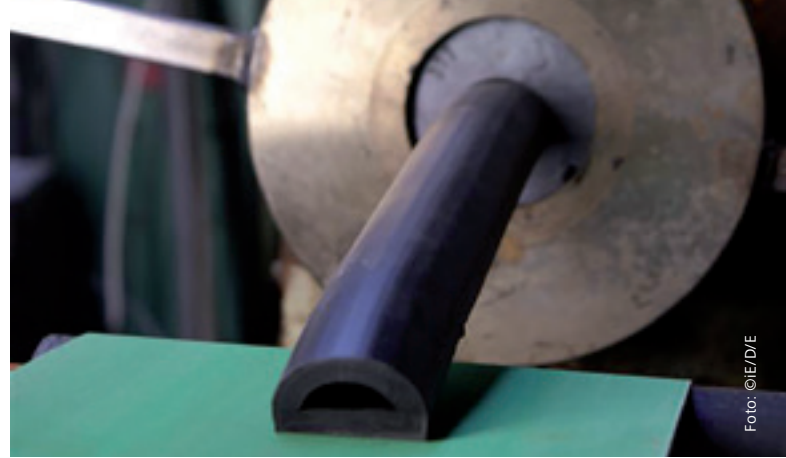
Extrusion von TPE durch angefertigtes Werkzeug nach Vorgabe.
